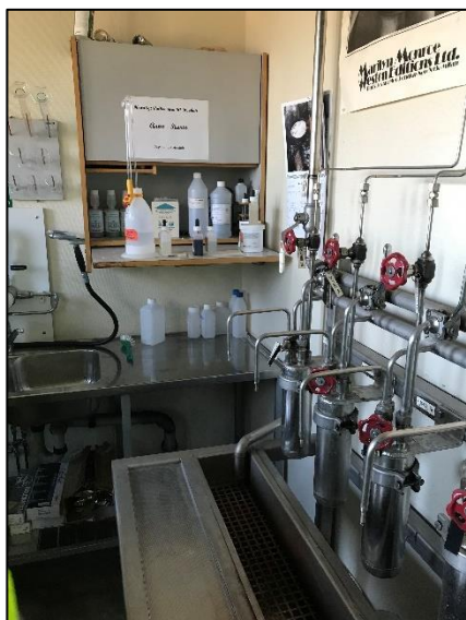
Figur 15 Laboratorium. Till höger i bild provpunkter för processvatten
