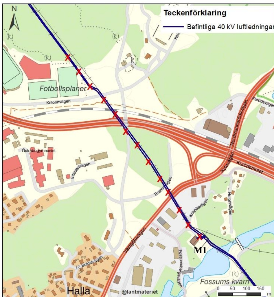
Figur 2. Röda kryss markerar sträckan som planeras rivas när markablarna anslutits till elnätet.
